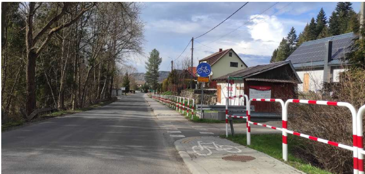
Rys. 30. Ul. Księdza Józefa Pułki w Ujsołach. Nieprawidłowo zaprojektowana infrastruktura rowerowa. Ciąg należy przeznaczyć na chodnik, a ruch rowerowy prowadzić w jezdni z zastosowaniem elementów wpływających na poprawę BRD oraz uspokojenie ruchu.
