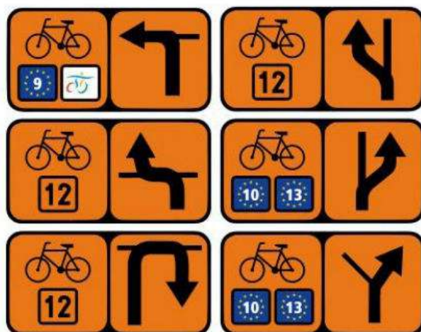
Rys. 38. Znak R-4a „informacja o rzeczywistym przebiegu szlaku rowerowego”.
