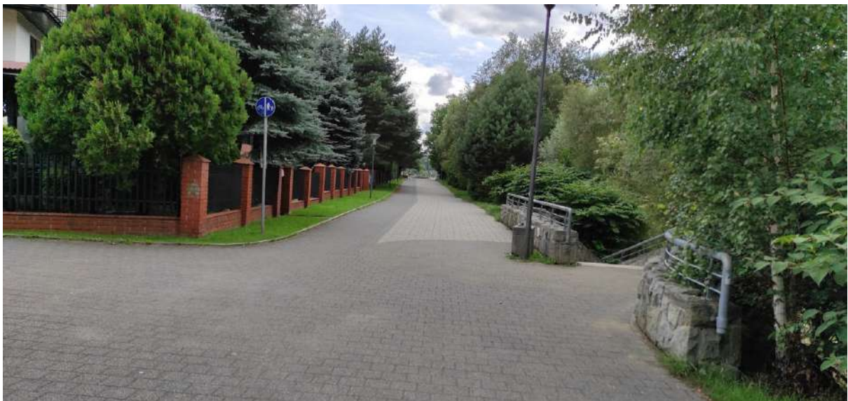
Rys. 14. Istniejąca droga dla rowerów i pieszych wzdłuż rz. Soły, w rejonie ul. 3 Maja. Odcinek wymaga remontu nawierzchni (wymiana na nawierzchnię bitumiczną) wraz z dostosowaniem infrastruktury do przyjętych w opracowaniu Standardów Rowerowych. Węgierska Górka.
