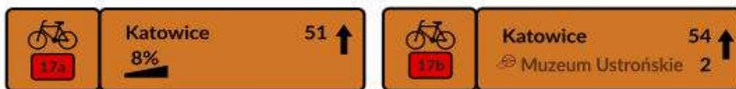
Rys. 42. Przykład znaku R-4d prowadzącego przez różne warianty do trasy nr 17.
