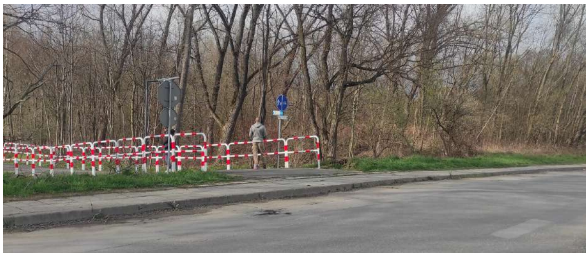
Rys. 12. Istniejąca droga dla rowerów i pieszych jest nieprawidłowo włączona do ulicy Jana Pawła II (między innymi przez brak obniżonego krawężnika). Oznakowanie pionowe typu C-13/16 (z kreską pionową) w przypadku braku wydzielenia części przeznaczonej dla rowerzystów na drodze dla rowerów i pieszych (oznakowaniem poziomym lub konstrukcyjnie), należy zastąpić oznakowaniem drogi dla rowerów i pieszych w ruchu mieszanym - oznakowanie C-13/16 z kreską poziomą. Węgierska Górka.
