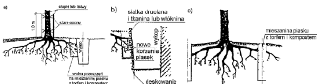
a) przekrój ogólny, b) szczegóły wykopu, c) wstępna faza zabezpieczenia, wykonywana najlepiej rok przed właściwym wykopem
